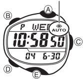
La presentación del reloj se ilumina mediante el uso de un panel EL (electroluminiscente) para una fácil lectura en la oscuridad. El interruptor de luz automática del reloj, activa automáticamente la iluminación cuando inclina el reloj hacia su cara.
