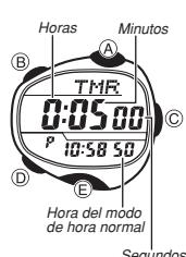
Puede ajustar el temporizador de cuenta regresiva dentro de una extensión de un minuto a 24 horas. Una alarma suena cuando la cuenta regresiva llega a cero.
