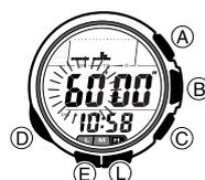
1. Lorsque le temps initial est affiché en mode Minuterie de compte à rebours, appuyez sur (E) jusqu'à ce que le réglage des minutes du temps initial se mette à clignoter, ce qui indique l'écran de réglage.
