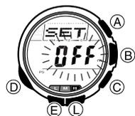
1. En mode Altimètre, appuyez sur **E** jusqu'à ce que **SET** apparaisse dans la partie supérieure de l'afficheur.
