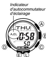
Un panneau EL (électroluminescent) éclaire tout le cadran de la montre pour que l'affichage soit mieux visible dans l'obscurité. L'autocommutateur d'éclairage de la montre s'active lorsque vous tournez la montre vers votre visage et à ce moment le cadran s'éclaire.
