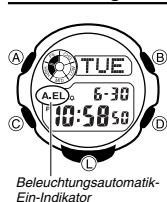
Die Uhr besitzt ein elektrolumineszentes Panel (EL-Panel), das das gesamte Display leuchten lässt, damit es im Dunkeln mühelos abgelesen werden kann. Die Beleuchtungautomatik der Uhr schaltet die Beleuchtung automatisch ein, wenn Sie die Uhr zum Ablesen auf das Gesicht richten.
