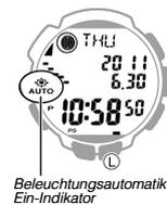
Halten Sie im Uhrzeitmodus etwa drei Sekunden lang (L) gedrückt, um die Beleuchtungsautomatik ein- (A) (angezeigt) und auszuschalten (A) (nicht angezeigt).
