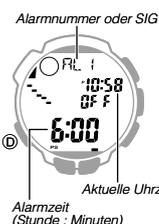
Sie können fünf voneinander unabhängige tägliche Alarmer einstellen. Wenn ein Alarm eingeschaltet ist, ertönt täglich etwa 10 Sekunden lang ein Alarmton, wenn die Uhrzeit des Uhrzeitmodus die eingestellte Alarmzeit erreicht. Dies ist auch der Fall, wenn die Uhr nicht auf den Uhrzeitmodus geschaltet ist. Sie können auch ein Stundensignal einschalten, bei dem die Uhr jede volle Stunde durch zweimaliges Piepen meldet.
