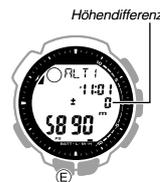
Drücken Sie im Höhenmessmodus den Knopf **(E)**. Die Uhr misst die Höhe und registriert das Resultat als den Höhendifferenzwert-Ausgangspunkt. Der Höhendifferenzwert wird dabei auf Null rückgesetzt.
