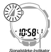
Während des manuellen Empfangs zeigt der Signalstärke-Indikator wie unten gezeigt die Signalstärke an.
