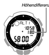
Die Anzeige des Höhenmessmodus umfasst auch einen Höhendifferenzwert, der die Höhenänderung gegenüber einem von Ihnen festgelegten Bezugspunkt anzeigt. Der Höhendifferenzwert wird mit jeder Höhenmessung durch die Uhr aktualisiert.
