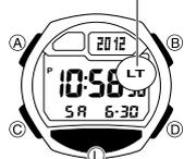
Das Display der Armbanduhr wird durch eine LED (lichtemittierende Diode) und ein Lichtleitpanel beleuchtet, sodass auch im Dunkeln ein problemloses Ablesen gewährleistet ist. Der automatische Beleuchtungsschalter der Armbanduhr schaltet die Beleuchtung ein, wenn Sie die Armbanduhr in einem bestimmten Winkel gegen Ihr Gesicht gerichtet halten.
