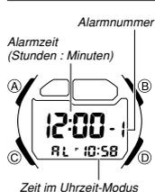
Sie können fünf unabhängige tägliche Alarmer einstellen. Wenn ein Alarm eingeschaltet ist, ertönt der Alarm, sobald die eingestellte Alarmzeit erreicht wird. Einer der Alarmer kann als Schlummeralarm oder als einmaliger Alarm konfiguriert werden, wogegen die anderen vier Alarmer jeweils einmalige Alarmer sind.
