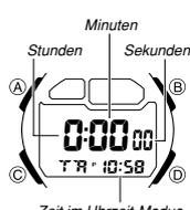
Sie können den Countdown-Timer in einem Bereich von 1 Minute bis zu 100 Stunden einstellen. Ein Alarm ertönt, wenn der Countdown Null erreicht.
