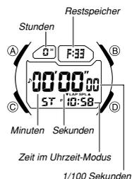
Die Stoppuhr mit einer Messgenauigkeit von 1/100 Sekunde kann die abgelaufene Zeit sowie Runden-/Zwischenzeiten messen. Die Stoppuhr verwendet die von Ihnen eingegebenen grundlegenden Daten und ein Schrittgebersignal, um die beim Joggen oder Laufen zurückgelegte Strecke zu berechnen. Die Stoppuhrzeiten und die von Ihnen zurückgelegte Strecke werden ebenfalls im Speicher abgespeichert.
