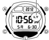
L'affichage de la montre est éclairé par une DEL (diode électroluminescente) et un panneau lumineux qui permettent de le voir même dans l'obscurité. L'autocommutateur d'éclairage allume l'affichage lorsque vous orientez la montre vers votre visage.
