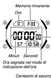
Il cronometro a centesimi di secondo è in grado di misurare il tempo trascorso e i tempi di giro/tempi parziali. Il cronometro utilizza i dati di base introdotti dall'utente e un segnale di andatura per calcolare la distanza percorsa facendo jogging o correndo. Anche i tempi di cronometraggio e la distanza vengono memorizzati nella memoria.
